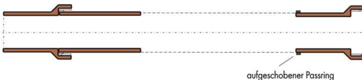
La longueur de la dérivation est d'abord découpée, plus environ 30 à 40 cm pour la pièce d'ajustement nécessaire. La bague P est installée en respectant le sens d'écoulement et le manchon de la dérivation insérée.
