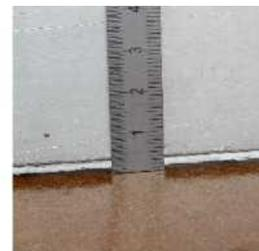
La mesure doit toujours être effectuée sur l'extérieur du tuyau, les mesures sur l'intérieur du tuyau ne fournissant pas de résultats utilisables.
